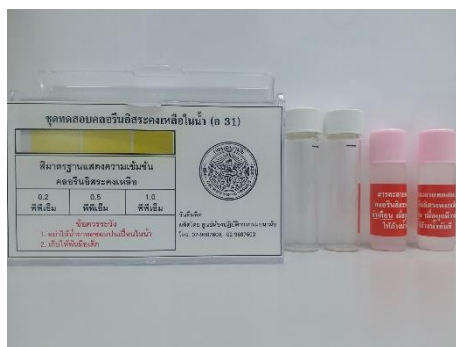
อุปกรณ์ชุดทดสอบคลอรีนอิสระคงเหลือในน้ำดื่ม อ 31
